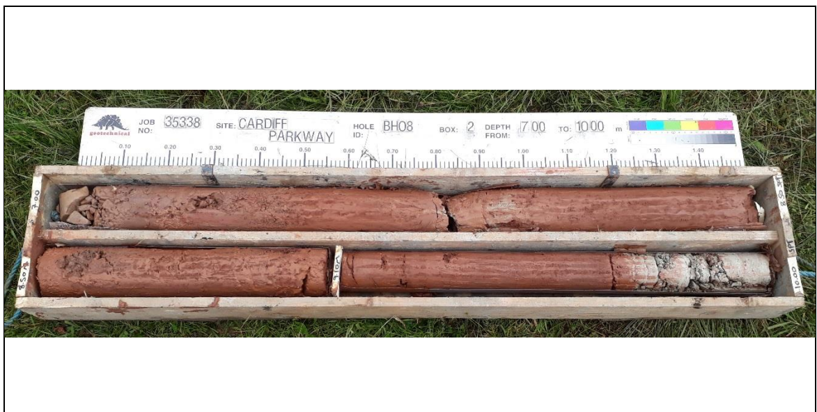
Borehole: BH08 Box 2 7.00-10.00m
